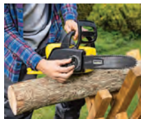
Tensado de la cadena sin herramientas
