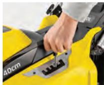
Ajuste de la altura de corte
